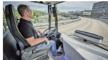
Die Kamera im Frontfenster übernimmt via CityPilot die Führung, der Fahrer greift nur im Notfall ans Lenkrad.
